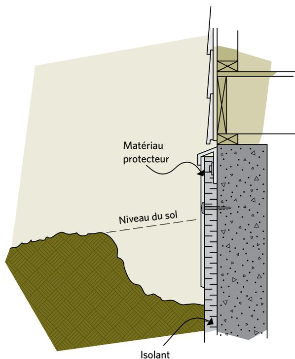
allouée pour permettre le tassement. Cette façon de faire éloigne de l'isolant les eaux de ruissellement; la pose de gouttières aidera également à éloigner les eaux de surface de la fondation sur au moins deux mètres (6 pi).
