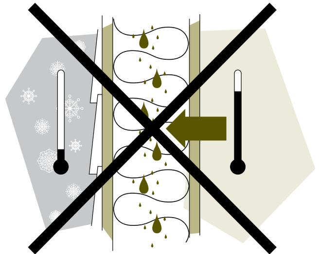
Par contre, un degré d'humidité supérieur à 40 p. 100 peut entraîner la formation de givre et de buée sur les fenêtres ainsi que de taches sur les murs et les plafonds, l'écaillage de la peinture, la moisissure et des mauvaises odeurs. Lorsque l'humidité relative est supérieure à 50 p. 100, les maladies transmises par l'air sont plus difficiles à éviter.
