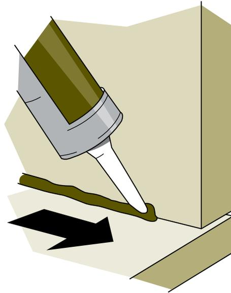
Tenir le pistolet à calfeutrer dans un angle perpendiculaire à la ligne à remplir. Couper le bout à angle droit. Le produit est forcé dans la fissure.
