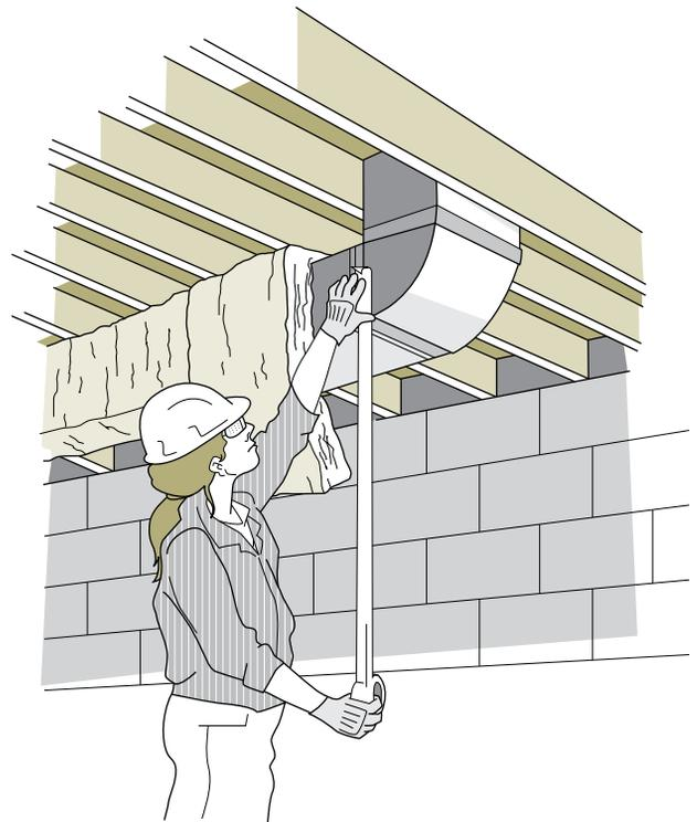
en rouleau pour obtenir une valeur RSI 2,1 (R-12) ou plus, ou utilisez des matelas en fibres minérales avec aluminium spécialement conçus pour cet usage. Enroulez l'isolant autour des conduits et fixez-le au moyen d'une corde, d'un câble ou d'un ruban approprié – n'utilisez pas de ruban de type vinyle.
