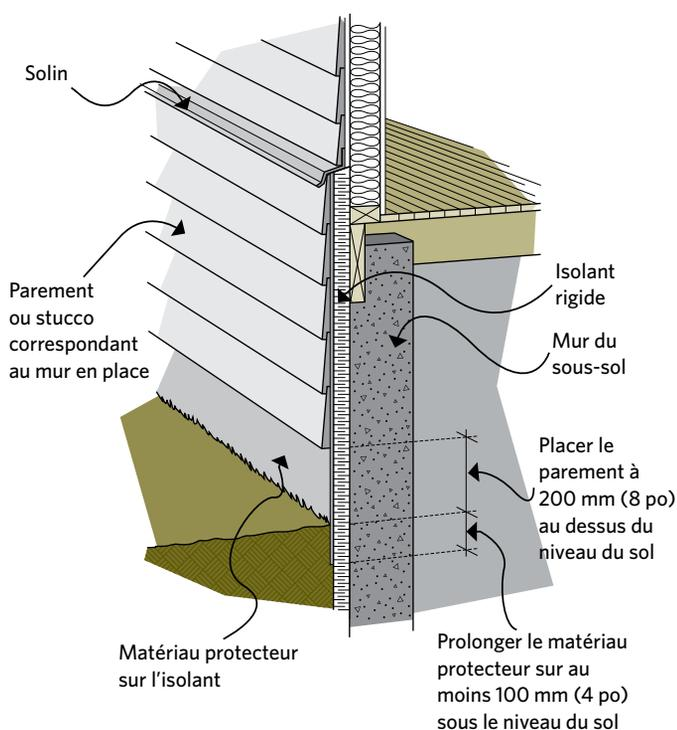
Figure 6-9 La protection extérieure doit s'étendre sous le niveau du sol
