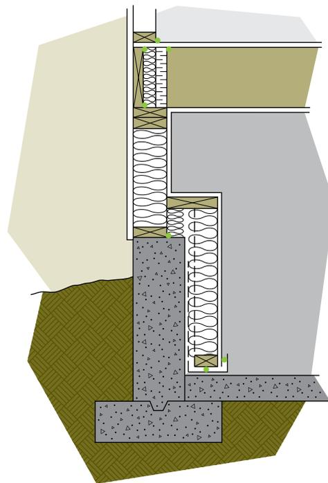
**Figure 6-21** Les surplombs doivent être scellés avant d'être isolés
