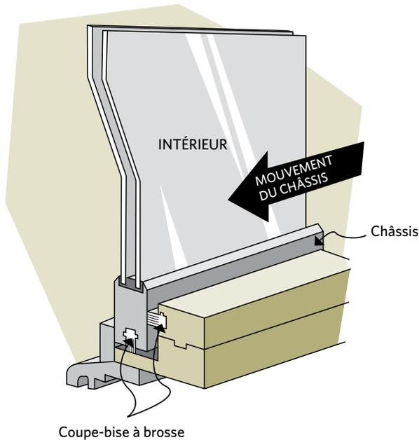
**Figure 8-7** Coupe-bise à compression et à balayage sur une fenêtre à battants
