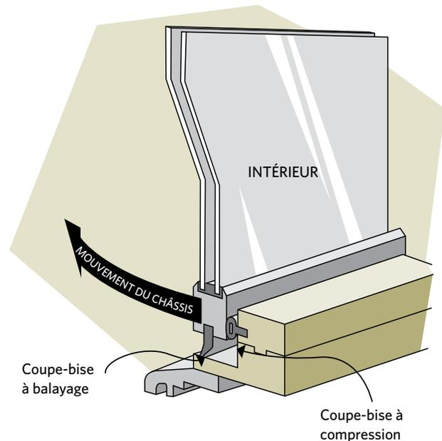
Les fenêtres à panneaux de verre coulissants – constituées de carreaux de verre qui ne sont pas insérés dans un cadre – sont peu efficaces. Il faudrait, à tout le moins, leur ajouter des contre-fenêtres intérieures. Une meilleure solution consiste à les remplacer par un modèle éconergétique.
