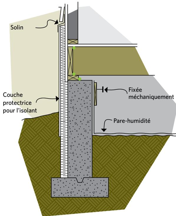
suivant les directives de la section 6.2.2 Isolation de l'intérieur avec mur à ossature. Si vous utilisez de l'isolant en mousse, demandez à l'inspecteur en bâtiment de votre région s'il est nécessaire de poser un revêtement ignifuge dans le vide sanitaire.
