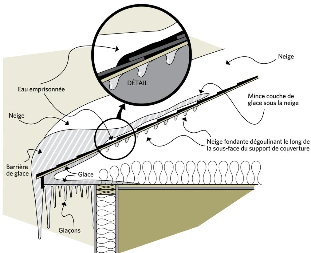
Si l'air et le surplomb sont à une température inférieure à 0 °C (32 °F), l'eau qui y coule gèle et amorce le processus de formation d'une barrière de glace. En outre, les murs foncés exposés au sud et chauffés par les rayons du soleil peuvent créer des courants chauds de convection qui pénètrent par le surplomb puis dans l'espace sous le toit, provoquant la formation de barrières de glace.
