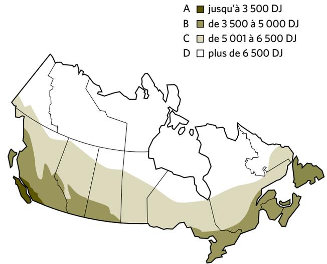
Les degrés-jours (DJ) sont une mesure des besoins en chauffage basée sur la différence entre la moyenne des températures extérieures journalières et 18 °C (65 °F). Les totaux cumulatifs pour le mois ou la saison de chauffage sont utilisés pour évaluer les besoins en énergie pour le chauffage. Chaque zone de la carte représente une région ayant un nombre de DJ comparable.
