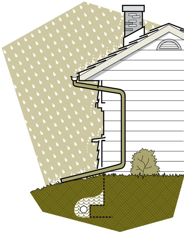
construction (p. ex., un plan de drainage) qui permettent à l'eau de s'écouler et empêchent la pluie de pénétrer. De plus, il faut prendre des mesures, comme assurer un drainage adéquat, prévoir une pente sur le terrain et imperméabiliser, afin de protéger la fondation des fuites souterraines ou de l'humidité s'infiltrant par diffusion capillaire.
