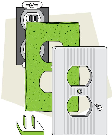
**Figure 3-4** Corps de joint en mousse
