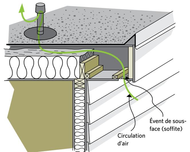
Assurez-vous que les fuites d'air dans le toit sont scellées du dessous. C'est chose difficile à cause des fils et des colonnes de plomberie qui passent normalement en plusieurs endroits du plafond. De plus, il se peut que les cloisons ne soient pas complètement fermées dans le haut, laissant échapper de bonnes quantités d'air directement dans le plafond.
