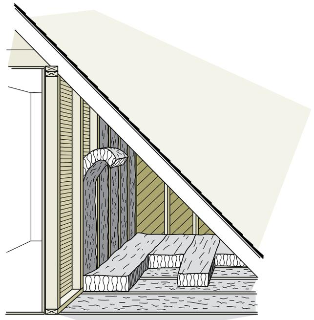
rigides qui rempliront les espaces entre les solives du plafond et scellez-les en place au moyen d'un produit de calfeutrage ou d'une mousse à vaporiser.
