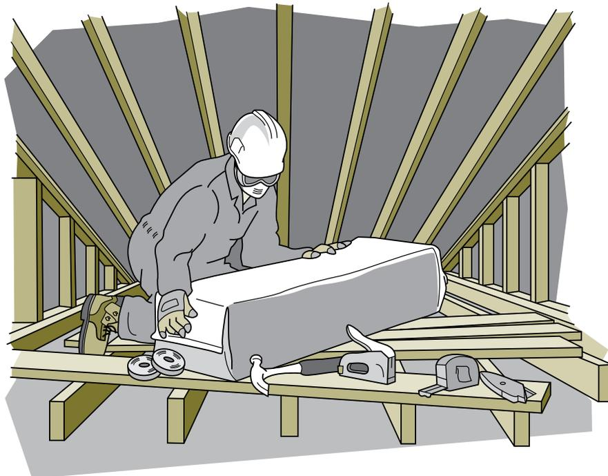
causer des dommages à la charpente, comme le pourrissement du bois ou le fendillement des chevrons. La moisissure et la pourriture sont des indices de problèmes avancés de condensation. Il faudra en identifier les causes et les régler avant d'ajouter l'isolant.
