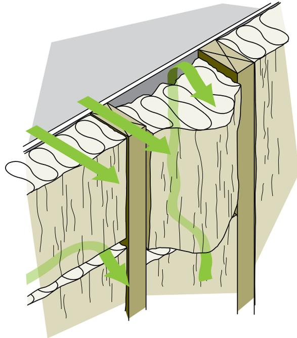
Les poteaux en bois forment un pont thermique et les vides dans l'isolant permettent aux courants d'air de circuler par convection.
