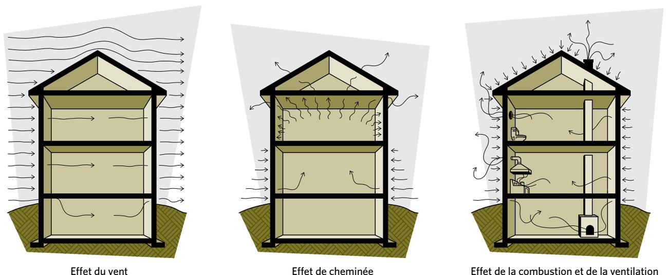
créé une pression plus basse près du niveau inférieur de la maison, ce qui tire l'air extérieur par les fissures et les ouvertures (p. ex., les fenêtres du sous-sol et les espaces entre les solives).
