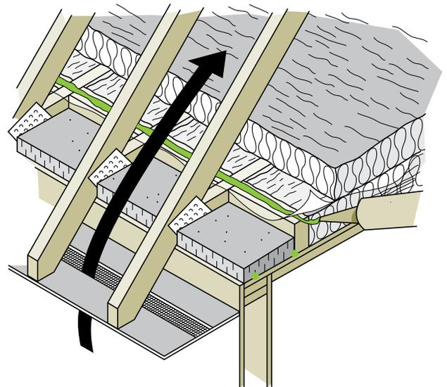
Des panneaux rigides de mousse sont posés aux débords de toit afin de maintenir la surface de ventilation.
