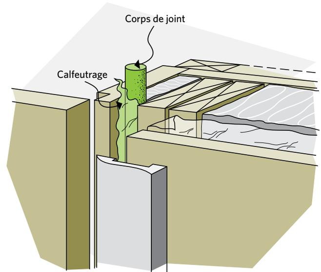
à colmater derrière. Isolez les grandes fissures à l'aide d'un corps de joint en mousse et bouchez-les avec un produit de calfeutrage, une mousse de polyuréthane ou tout autre produit approprié. Si vous enlevez les plinthes, vous pourrez aussi calfeutrer entre le fini du mur et le bas de la lisse basse, de même qu'entre la lisse basse et le plancher.
