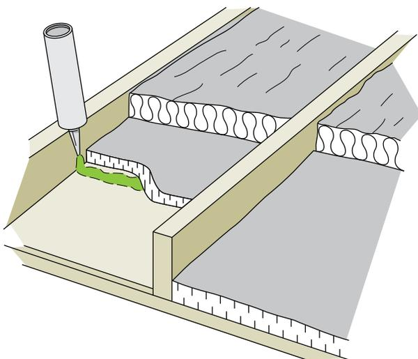
**Figure 5-11** Les déflecteurs peuvent assurer la circulation d'air à partir des événements de débord de toit
