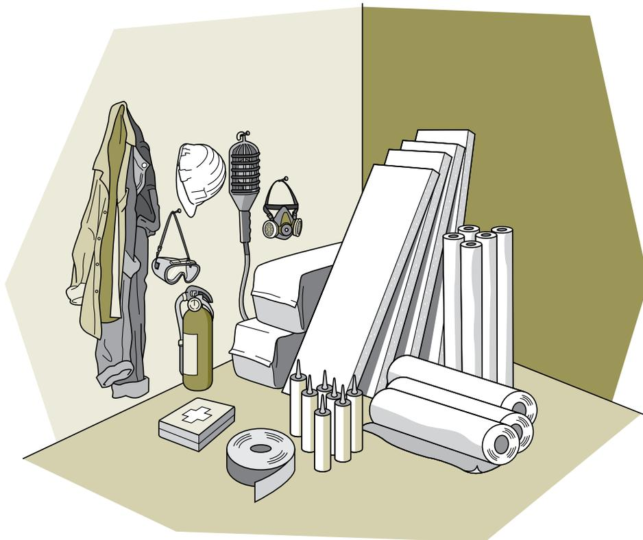
**AVERTISSEMENT DE SÉCURITÉ :** Ne jamais poser l'isolant en contact avec une cheminée ou un évent de combustion, un luminaire encastré exposé ou une filerie bouton et tube, ce qui poserait un risque d'incendie. Voir la section 1.4 Mesures de santé et de sécurité.
