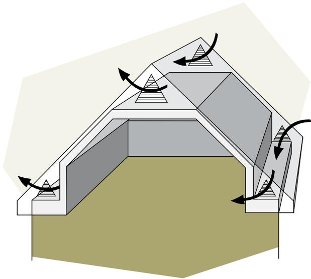
**Figure 5-19** La ventilation se fait entre les sections grâce aux événements d'entretoit installés entre les chevrons
