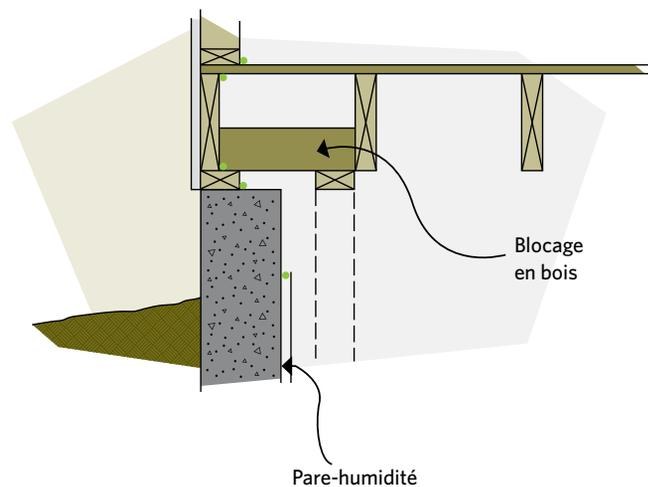
pour le revêtement envisagé. Il faut veiller à ce que les poteaux soient parfaitement verticaux et espacés afin qu'ils enserrent bien l'isolant et que le matériau de finition puisse être installé sans problème. Mesurez chaque poteau séparément. Il faudra une charpente supplémentaire autour des portes du sous-sol, mais les ouvertures des fenêtres ne requièrent qu'un seul poteau puisque le mur est non porteur.
