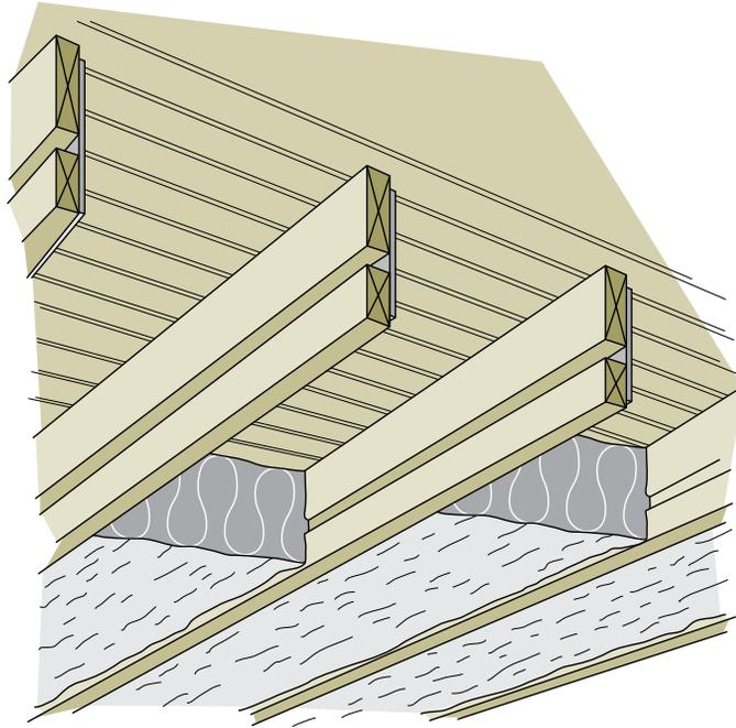
**Figure 5-25** Un nouveau toit isolé peut être construit sur l'ancien
