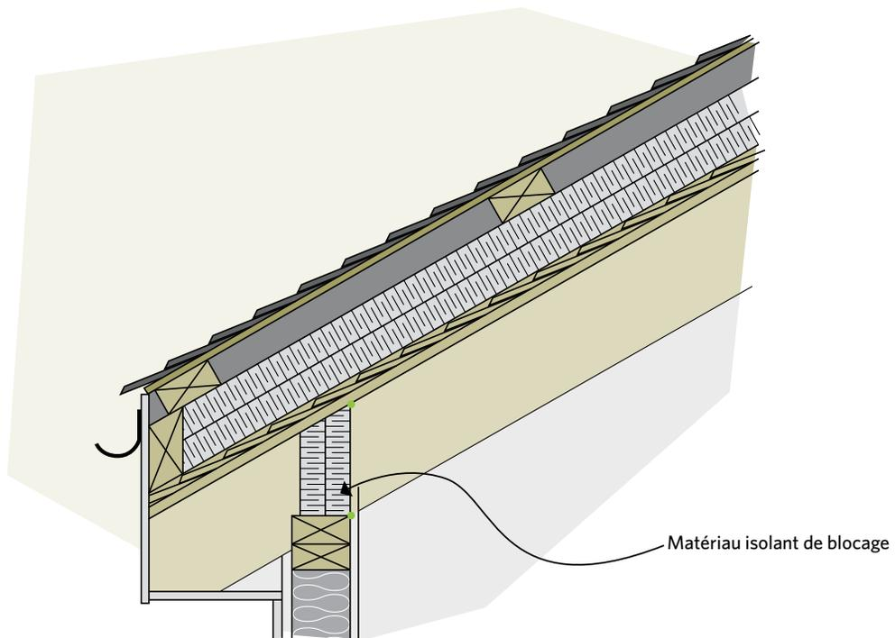
Il faut d'abord placer une feuille de polyéthylène sur le toit existant pour fournir un pare-air-vapeur en suivant la règle un tiers-deux tiers. Vous pouvez également pulvériser une couche de mousse à alvéoles fermées ou poser des panneaux rigides peu perméables dont les joints sont scellés pour empêcher les fuites d'air. Cette étape n'est pas nécessaire s'il y a déjà un pare-air.
