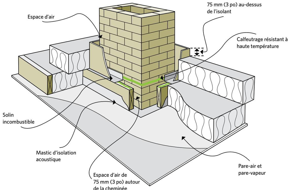
scellez tous les joints à l'aide d'un produit ignifuge (assurez-vous que l'utilisation à cette fin est précisée par le fabricant). Pour empêcher l'isolant (surtout dans le cas d'un isolant soufflé) d'entrer en contact avec la cheminée, construisez un écran éloigné de 75 mm (3 po) à partir de la cheminée et dépassant d'au moins 75 mm (3 po) le dessus de l'isolant.
