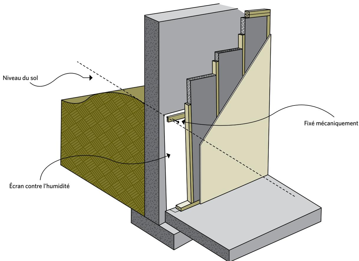
et l'humidité pénétraient le mur isolé, il se formait de la condensation sur le plastique qui provoquait des problèmes de fuites d'eau et de moisissures à l'intérieur du mur.
